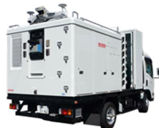
道路トンネル検査点検専用車両
