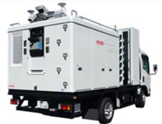
道路トンネル検査点検専用車両
