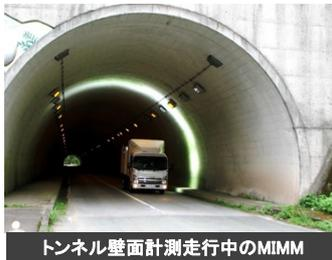
トンネル壁面計測走行中のMIMM
